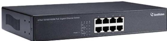
IEEE802.3at 規格(PoE+)対応し、装置全体で最大 130W までの PoE 紹電が可能です。 (4 ポート使用時は 1 ポートあたり 30W、8 ポート 使用の場合 1 ポートあたり 15.4W の紹電が可能) 本体は、放熱性に優れた金属筐体を採用し、筐体の発熱を最大限抑えます。
