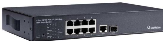
GV-POE0801 は、10/100M PoE+対応 8 ポートマネージメントスイッチングハブです。 IEEE802.3at 規格(PoE+)対応に対応し、装置全体で最大 130W までの PoE 給電が可能です。(4 ポート使用時は 1 ポートあたり 30W、8 ポート使用の場合 1 ポートあたり 15.4W の給電が可能) また、ギガビットアップリンクポートを 2 つ搭載(TPx1、SFPx1)し、ハブ同士を接続するカスケード接続に対応します。
